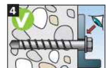
Na het vastschroeven mag het niet mogelijk zijn de schroef licht verder te draaien. De schroefkop moet op het bevestigingsdeel rusten en mag niet beschadigd zijn.
