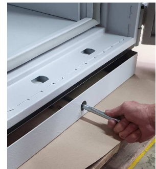
8. Schuif de bevestigingsas van voren
