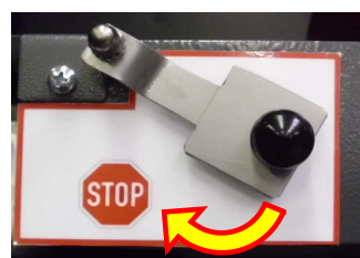
Rückhol Sperre gesperrt (ausgelöst)
