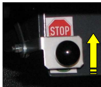
Rückhol Sperre gesperrt (ausgelöst)
