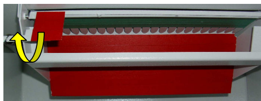
Rückhol Sperre gesperrt (ausgelöst)
